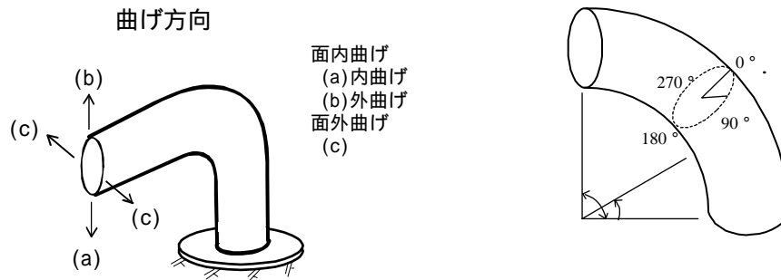
図2 曲管の曲げ方向と角度
