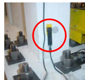
写真 3 RC建物模型振動台実験とスマート A E センサ
