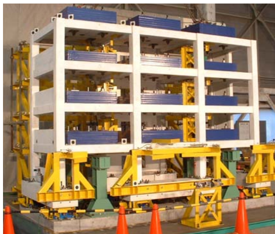
写真 3 RC建物模型振動台実験とスマート A E センサ
