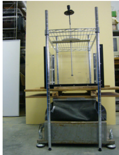
図18 ハンドベーン試験器の設置の様子
