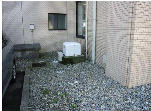
写真 2.2 震度計の設置状況
