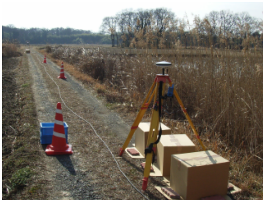
図5 地震計の設置状況 (No. 3 荒川河川敷)。段ボール箱は風よけで、それぞれの箱に1成分ずつ地震計がおかれている。三脚はGPSのアンテナと端末。
