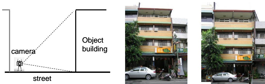
図13 現場で撮影された建物壁面画像の補正
