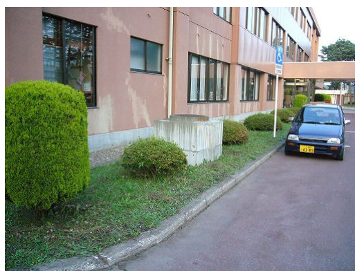
写真 4.2 震度計の設置状況
